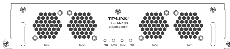
图1-10 TL-FAN100后面板示意图
